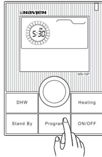
Нажмите кнопку "**Program**" («Таймер») для завершения установки. Если установка завершена, Пульт управления вернется к состоянию "**OFF**" («Выкл»).
