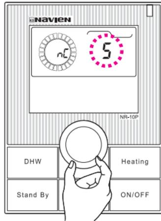
Поверните круговую шкалу, для установки желаемого времени обратного цикла, которое находится в диапазоне от **0** мин. до **10** мин.
