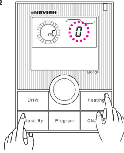
Нажмите и одновременно удерживайте кнопки “ON/OFF” («ВКЛ/ВЫКЛ») и “Stand By” («Режим ожидания») в течение 3 секунд, знак “nC” появится внутри циферблата, и желаемое время обратного цикла отразится там, где показывалась температура.
