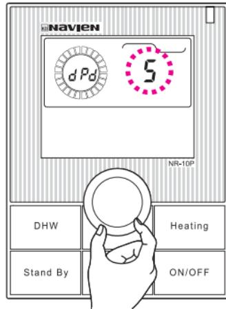
Поверните круговую шкалу, чтобы установить желаемое время предварительного нагрева горячей воды, которое находится в диапазоне от 0 мин. до 20 мин.
