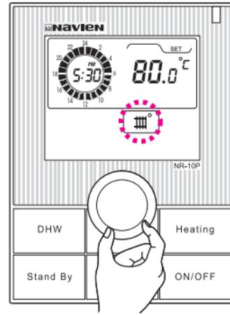
Нажмите кнопку **“Heating”** (“Отопление”), и, когда замигает символ (“температура отопления”), используйте центральную круговую шкалу для установки желаемой температуры в диапазоне 30~85°C. Отпустите кнопку, установка на дисплее произойдет автоматически.
