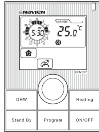
После установки таймера для требуемых временных интервалов, не трогайте пульт, и изменения автоматически зафиксируются на дисплее.
