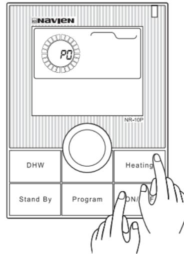
Нажмите и одновременно удерживайте кнопки “**ON/OFF**” («ВКЛ/ВЫКЛ») и “**Heating**” («Отопление») в течение 3 секунд, знак “**PO**” появится внутри циферблата, и желаемое время выбега насоса отразится там, где показывалась температура.
