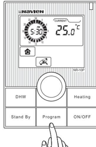
Используйте центральную круговую шкалу для установки «минут» и нажмите кнопку **"Program"** («Таймер»), замигают «часы». Используйте центральную круговую шкалу для установки часов. Нажмите кнопку **"Program"** для выбора режима **AM** или **PM**. Отпустите кнопку и установка на дисплее произойдет автоматически.
