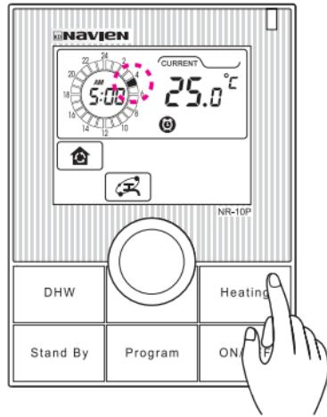
Нажмите кнопку “**Heating**” ( “отопление”) для включения (темное закрашивание) или отключения (пробел) требуемого временного интервала. Когда блок закрашен (“■”), секция активирована для указанного временного интервала.
