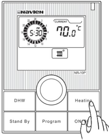
Нажмите кнопку **“Heating”** (“Отопление”) до того момента как появится символ (“температура отопления”).
