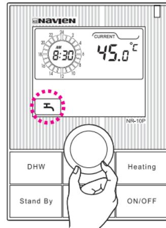
При нажатии кнопки **"DHW"** («ГВС»), на дисплее появляется символ и отображается температура горячей воды (**30~50°C**). Если необходима температура выше **50°C**, следует одновременно нажать кнопки **"DHW"** («ГВС») и **"Heating"** («Отопление»). В этом случае пользователь может регулировать установленную температуру горячей воды в диапазоне до **65°C**.
