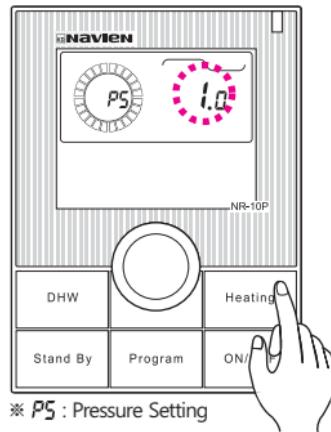
При удержании кнопки “Heating” («Отопление») в течение 3 секунд, появится знак “PS” внутри циферблата, и желаемый уровень давления воды отразится на дисплее, там, где показывалась температура.
