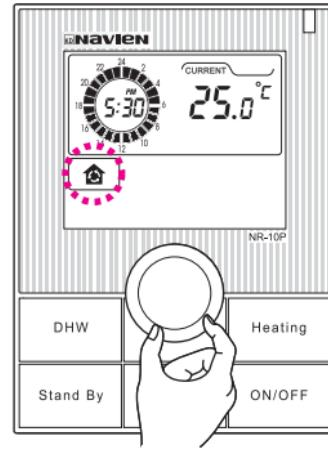
Нажмите кнопку **“Heating”** (“Отопление”) и, когда загорает символ (“температура обогрева комнаты”), используйте центральную круговую шкалу для установки желаемой температуры в диапазоне 10~30°C. Отпустите кнопку, установка на дисплее произойдет автоматически.
