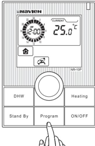
Нажмите и удерживайте кнопку **"Program"** («Таймер») в течение 3 секунд, на таймере замигают «минуты».
